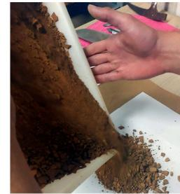
Recogida de muestras georreferenciadas con GPS, procesamiento de muestras (cuarteado, tamizado, secado, molido) y análisis con SEM-EDX y FRX / *GPS geo-referenced sample collection, sample processing (quartering, sieving, drying, grinding) and analysis by SEM-EDX and XRF.*
