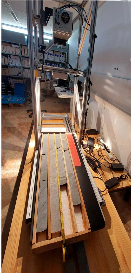
Adquisición de imágenes de los testigos de sondeos y muestras de mano con el uso del soporte de laboratorio / *Acquisition of images from core boreholes and hand-held samples using the laboratory rack.*
