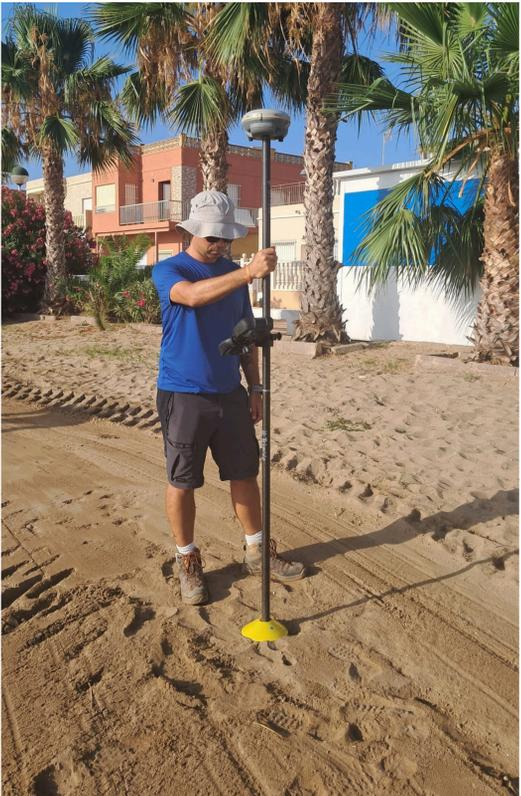
Apoyo al control del posicionamiento global de los trabajos geofísicos en campo / *Support for global positioning control of geophysical work in field.*
