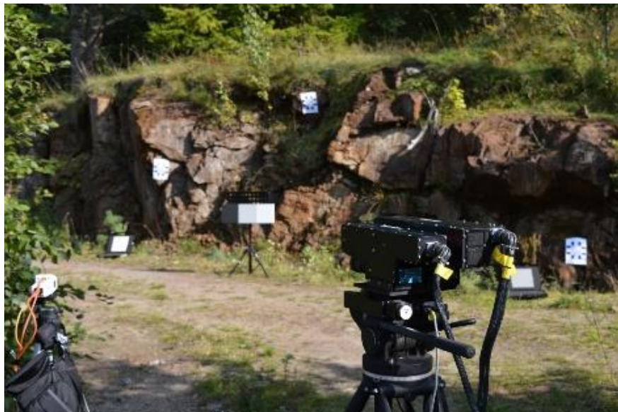
Figura 3: Sistema de espectrómetro de imagen Black HySpex (derecha) y Cubert UHD-185 blanco en una exploración de afloramiento
