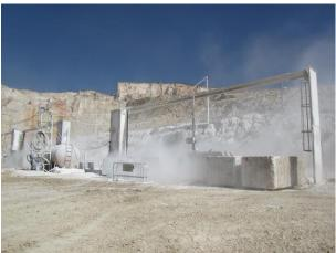
En el caso de la línea de corte, el operador tiene en primer lugar la misión de ubicar y estabilizar correctamente la máquina, así como introducir el hilo en las perforaciones que previamente se han realizado, tras la puesta en marcha del equipo el operador deberá de estar pendiente del avance del corte y de la alimentación de agua para refrigerar el hilo y captar la mayor cantidad de polvo producido.
