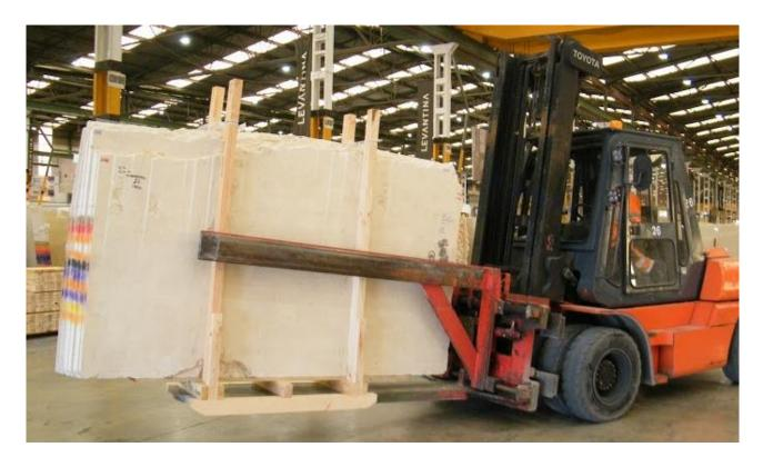
Hay muchos accesorios para las carretillas elevadoras, pero los más utilizados para la manipulación de roca ornamental son las pinzas para manipular tablas, así como otros accesorios en forma de gancho o una sola uña para la manipulación de paquetes de tablas.
